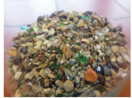
Fremdkörper-Beispiele, die von der Armatec-FTS-Balgpumpe ausgefiltert wurden
